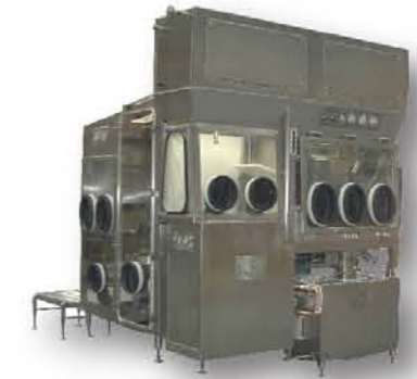
在隔离罩内用手套箱操作，用于特殊产品的生产
