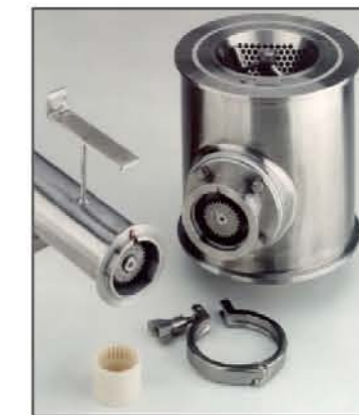
机头可拆卸，单独蒸汽消毒
