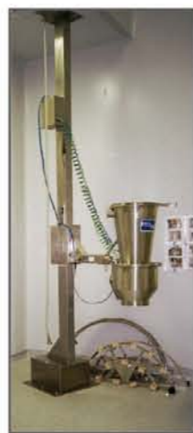
粉碎整粒机U20 与VAC真空传送 机连接
